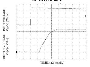
Start-up Using Input Voltage (VIN = 14V, Io = Io,max), Vo=3.3V, Ta=25°C
