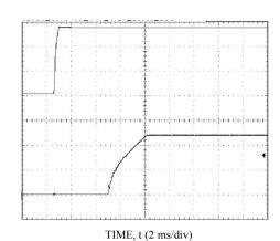
Start-up Using Input Voltage (VIN = 14V, Io = Io,max),
