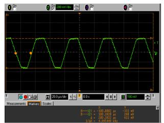
FIGURE 12. 22kHz TONE ON 13.3V<sub>OUT</sub> WITH 500mA LOAD
